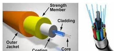
Gambar 2. Struktur dasar kabel *fiber optic*
